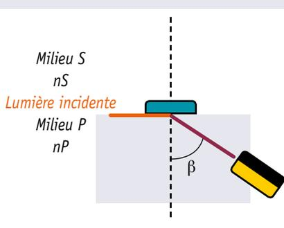
Le rayon de réfraction éclaire une partie du prisme. Au-delà de l'angle limite  $\alpha_{lim}$ , le prisme reste dans l'obscurité (réflexion).
