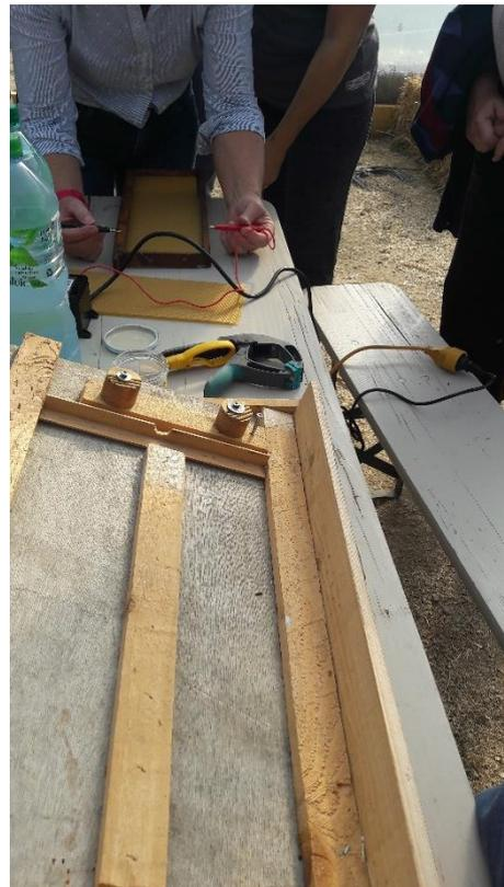
Nous avons vu également comment faire tenir la feuille de cire aux fils avec de quoi chauffer les fil à l'aide d'une petite batterie et de 2 cosses + et - que l'on va mettre en contact avec les extrémités du fil.
